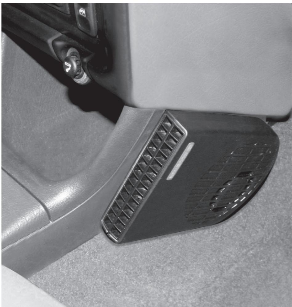
Kupévärmare monterad med bipackad fästplåt.
